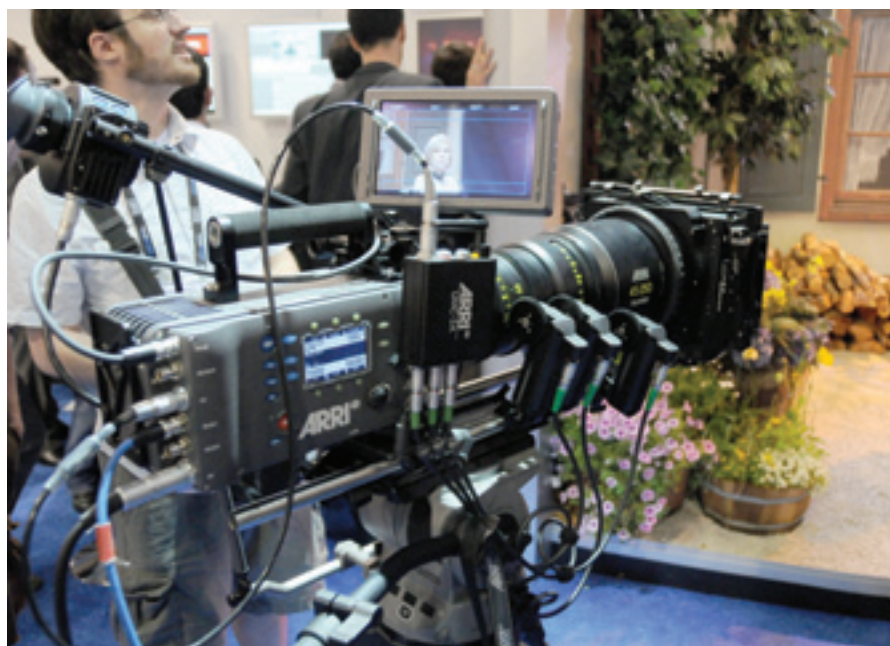
Камера ALEXA в комплекте с ЖК-монитором и системой дистанционного управления объективом
